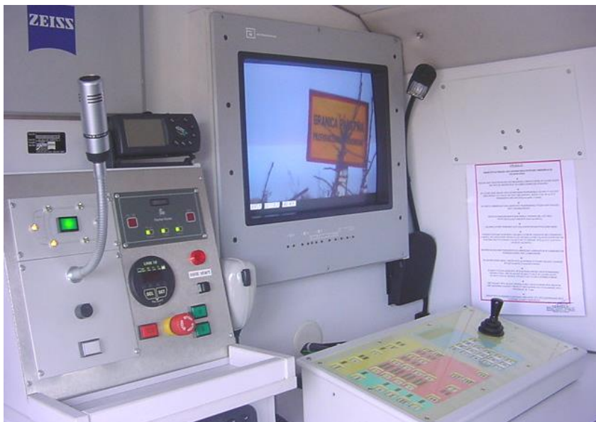
Pojazd obserwacyjny wyposażony w urządzenia termowizyjne do wykrywania osób
