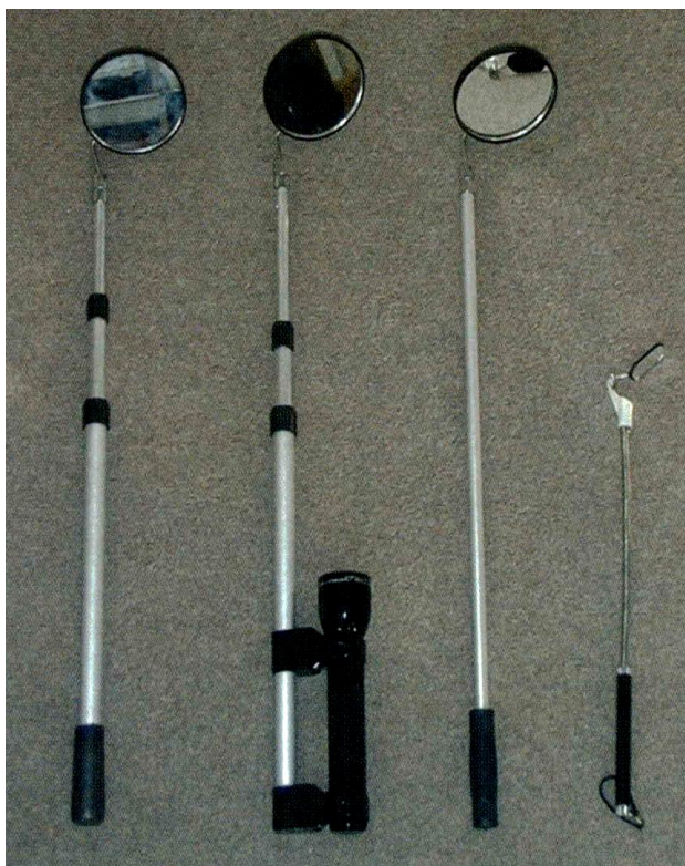
Lustra do przeszukiwań o różnej średnicy i długości teleskopu (z podświetleniem lub bez).
