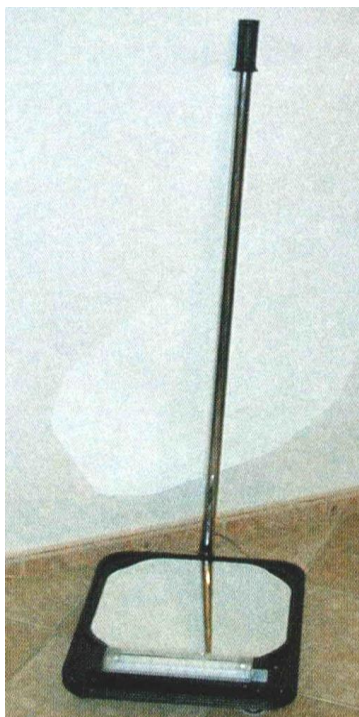
Lustro do kontroli pojazdów z podświetleniem lampą neonową, zasilaną akumulatorkiem 9V, na kółkach jezdnych.
