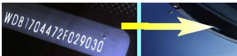
Numer VIN na podszybiu wyglądn i umiejscowienie
