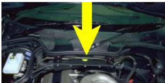
Wybity numer VIN i jego umiejscowienie
