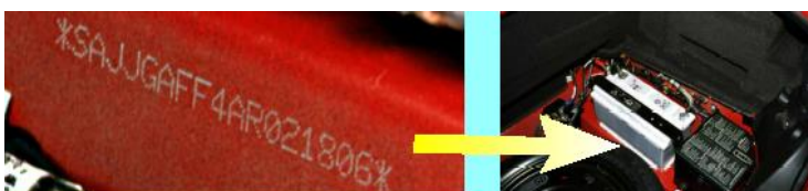
Wypalony numer VIN wygląd i umiejscowienie
