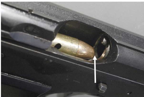
Fot. 5. Fragment zamka pistoletu CZ 75 „B” z widocznym nabojem opierającym się o wślizg komory naboju.
