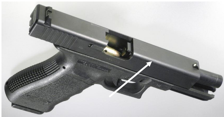
Fot. 6. Pistolet Glock 17, w którym łuska pozostała w komorze nabojeowej, a zamek zatrzymał się w położeniu pośrednim.
