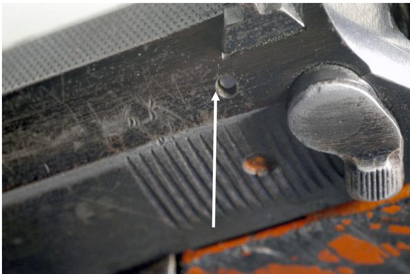
Fot. 1. Schowany wskaźnik naboju pistoletu P-83 (nie wystający poza obrys lewej krawędzi zamka) informuje, że w komorze nabojujowej nie ma naboju.
