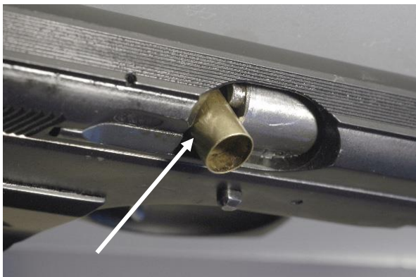
Fot. 8. Fragment zamka pistoletu CZ 75„B” z zakleszczoną łuską pomiędzy zamkiem, a tylnym ścięciem lufy.
