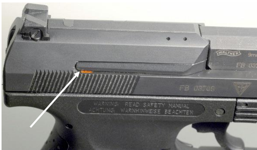
Fot. 2. Tylna część zamka P-99 Walthera z widocznym odchylonym wyciągiem (odslaniającym czerwoną plamkę) sygnalizującym nabój w komorze nabojewej.
