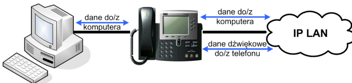
Rys. 2. IP Phone jako punkt dostępu do sieci.
