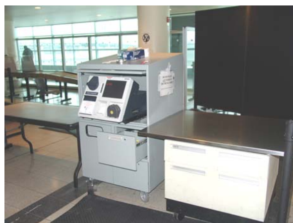
Urządzenia do wykrywania śladowych ilości MW – znajdują się przy każdym stanowisku kontroli bezpieczeństwa
