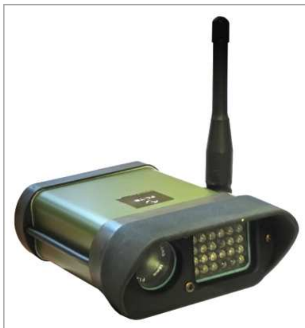
Kamera TV z oświetlaczem w podczerwieni
