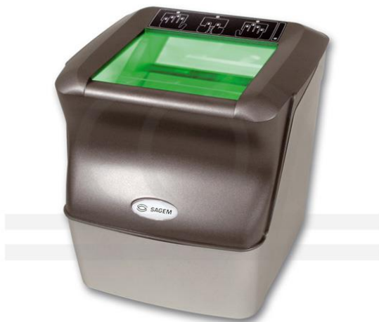
Fot. 11. Stacjonarny czytnik linii papilarnych 4 palców typu MORPHO TOP 100 – fot. własna
