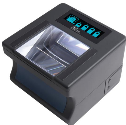
Fot. 10. Stacjonarny czytnik linii papilarnych 4 palców typu AGLIE TP – fot. własna
