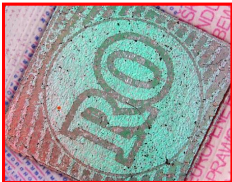
Fot.9 i 10. Prawo jazdy Rumunii – element dyfrakcyjny występujący w dokumencie wzorcowym (fot. po prawej) i imitacja zastosowana w dokumencie dowodowym (fot. po lewej)
