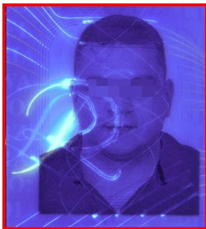
Fot. 1. Wtórny wizerunek posiadacza (widok w świetle UV) – imitowanie fragmentu zabezpieczenia specjalnego
